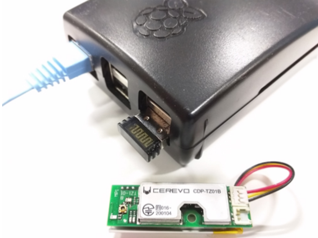
Raspberry Pi B+ & BLE Dongle
